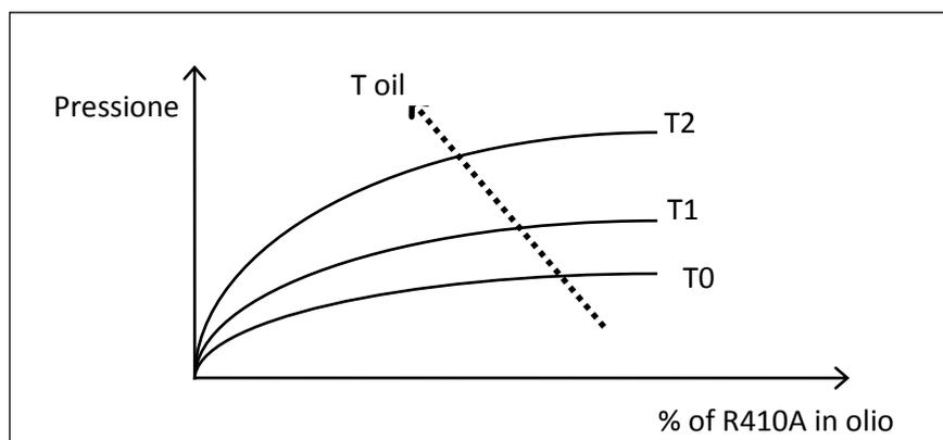
Il diagramma illustra la caratteristica [legge di Charles] dei gas a sciogliersi in un liquido in misura tanto maggiore quanto più elevata è la pressione e la contemporanea azione di contrasto della temperatura: a parità di pressione in coppa, un aumento della temperatura dell'olio riduce in maniera sensibile la quantità di refrigerante disciolta garantendo così il mantenimento delle caratteristiche di lubrificazione volute.
