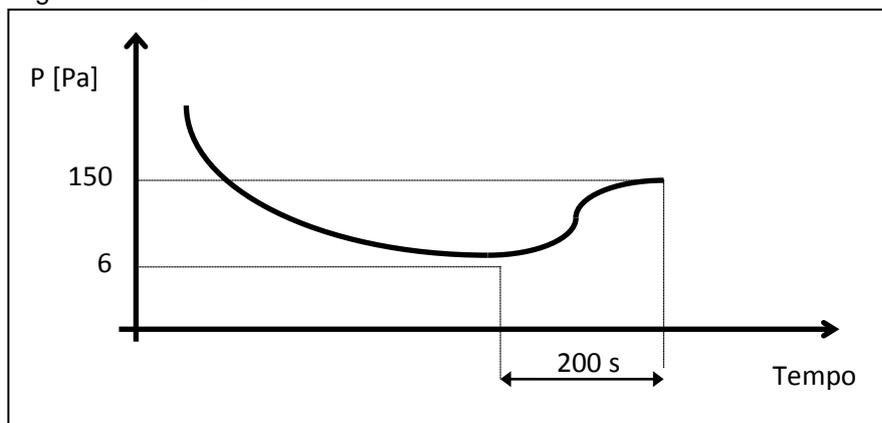
La fig. 9 rappresenta un ciclo di vuoto e successiva risalita della pressione ottimale per apparecchiature frigorifere quali quelle di nostra produzione. In generale nel caso di sospetto di forti idratazioni del circuito o di impianti molto estesi, si deve procedere alla "rottura" del vuoto con azoto anidro. Ripetere poi le operazioni di vuoto come sopra descritto. Tale operazione agevola la rimozione di umidità annidata e/o ghiacciata durante il processo di vuoto
